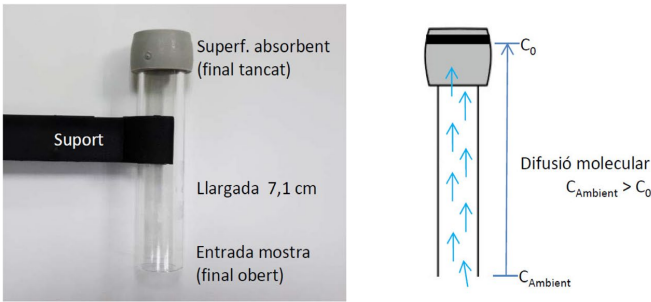
Figura 15. Principi de funcionament dels tub passius de difusió de \text{NO}_2 de tipus Palmes, on C_{\text{Ambient}} és la concentració de la mostra ambiental i C_0 és la concentració a la superfície de l'absorbent.
