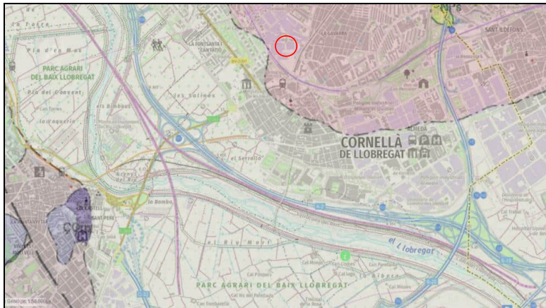
Plano geológico de la zona del ICC. En color rosado los depósitos del llano aluvial del llano de Barcelona. En color claro los depósitos cuaternarios del llano aluvial y/o delta del Llobregat (Holoceno).
