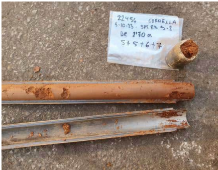
Foto 8: Sondeo S-2, SPT a 2,7 metros.
