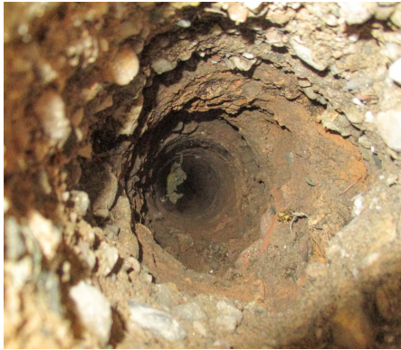
Imatge de un dels sondejos de prospecció. A la dreta ampliació punts de sondeig a la parcel·la 22a.1.
